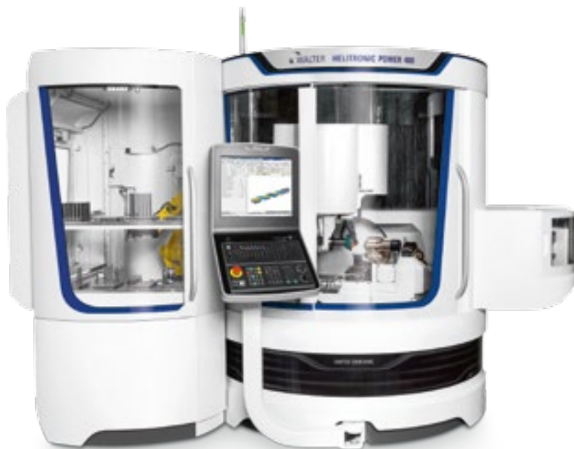
La HELITRONIC POWER 400 avec le changeur de meules et l'option « chargeur Robot »
