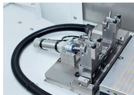
*L'équipement réduit de la machine a été adapté aux exigences de la rectification plane. Les options comprennent un dispositif de dressage universel avec équipement pneumatique (dr.)*
