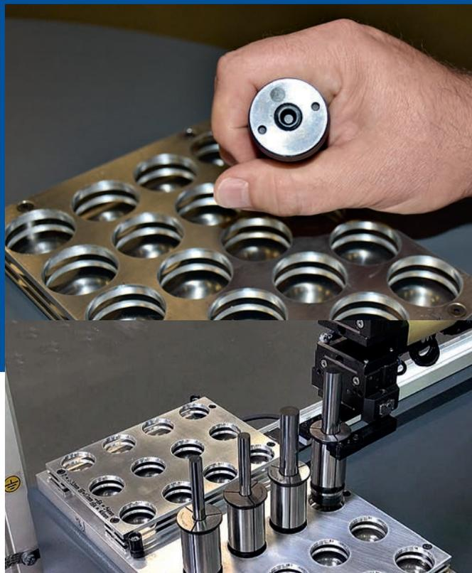
*Projet client : pince de serrage (type NK) avec système RFID pour la reprise en rectification automatisée avec différents diamètres d'outil au sein d'un lot*
