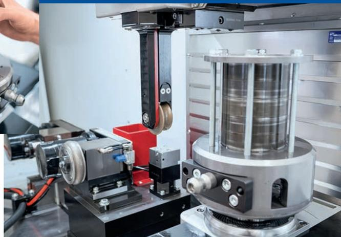
d'équilibrage manuel disponible en option. L'équipement pneumatique habituel pour les machines de la gamme PLANOMAT est supprimé. La machine d'entrée de gamme est commandée par un Siemens Sinumerik MCU 1720 et l'usinage de pièces individuelle BLOHM avec guidage graphique de l'opérateur. La petite armoire de commande de la PLANOMAT XT Essential tient compte de l'équipement et des options avec sa configuration matérielle modifiée.
