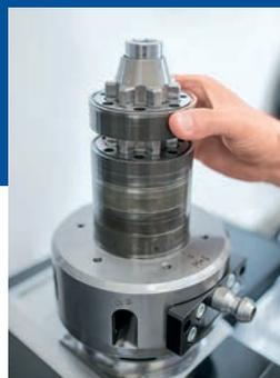
*Au lieu d'un bras de rectification horizontal, un bras vertical (dr.) en liaison avec un appareil diviseur à axe vertical (haut) est utilisé*
